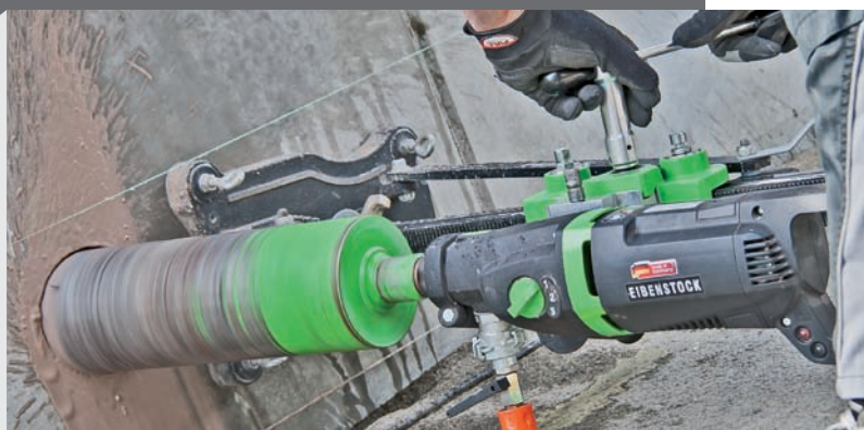
BST 182 V/S: auf vier Spezialkugeln gelagerter Schlitten
