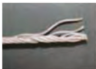
EFFILOCHAGE Câble visiblement distendu ou déroulé
