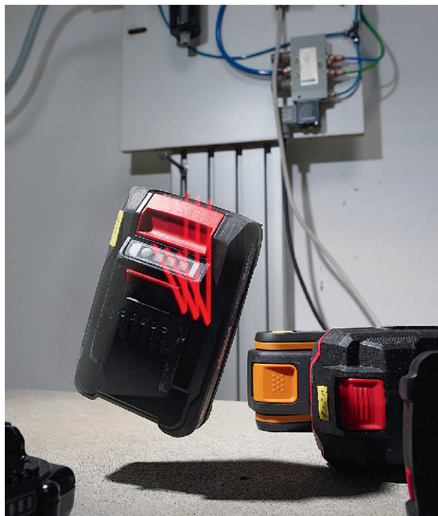
Im freien Fall. Jeder Akku musste sechs Stürze aus 1,5 Meter Höhe überstehen.
