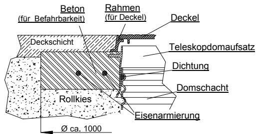
**Auftretende Lasten dürfen auf keinen Fall direkt auf den Tank übertragen werden.**
