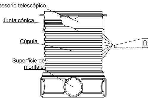
El anillo obturador se coloca en el encaje superior alrededor y se introduce por encima la cúpula telescopica (no olvide engrasar la junta). La cúpula telescopica debe ser soportada por tierra para que en caso de carga no descienda.
