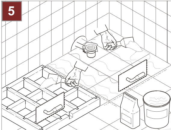
5. Auf beide Oberflachen (Untergrund und Unterseite des Tragers) wird Kleber (Flex-Fliesenkleber) mit Zahnpachtel aufgetragen.
